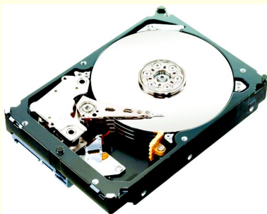
Жесткий диск компьютера, из которого добывается магнит.
